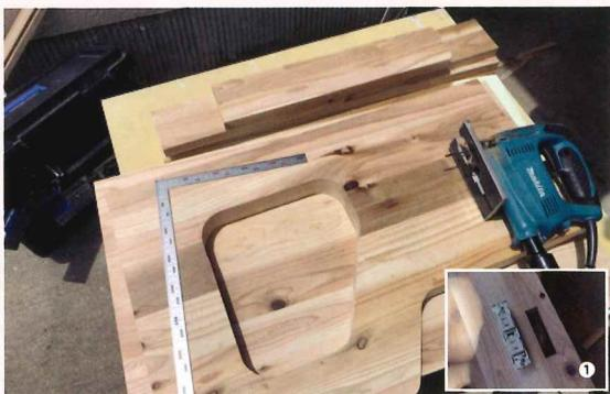
材料(杉の無垢ボード24mm×500巾×3m)を大体の大きさにカットして、パーツごとに加工します。強度的なことは少し考えましたが、形状は思い付きで適当な感じです。コンセントも必要なので、デスク天板に穴も開けました(写真①)。パーツの切り出しあえてしまえば、後は簡単です。
